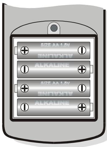
**Nach dem Batteriewechsel werden das Datum, die Uhrzeit, die Baudrate, die Art der Sonde, das Druckintervall, die Logging-Parameter wieder eingestellt: zur Vereinfachung schaltet sich das Gerät bei Einlegen der neuen Batterien automatisch ein und fordert der Reihe nach alle diese**
